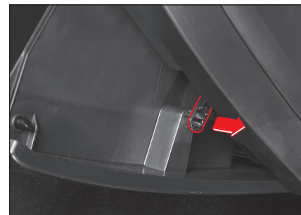
3. Déclencher le clip de l'amortisseur sur le côté inférieur droit de la boîte à gants.
